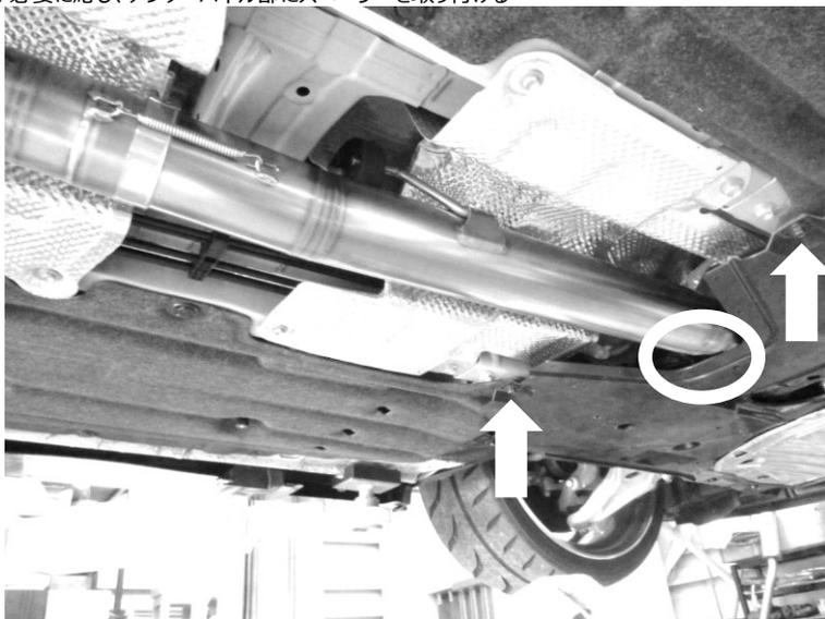
丸印の部分のクリアランスが少ない場合は、矢印の部分に付属のスペーサー/ワッシャー/M6ボルトを使用しクリアランスを確保してください。
