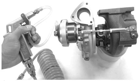
⑤ アクチュエータにセットされたスプリングよりも少し高めの圧力をかけてください。 圧力をかけるとアクチュエーターロッドが動いてスイングバルブブラケットと接続できるようになります。
