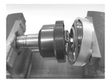
③ 本書2-1.アクチュエーターの分解を 参考にし、バイス(万力)などで アクチュエータースプリングを縮めて くロックリングで固定してださい。
