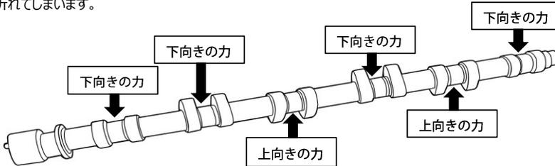
カムシャフトを組み付ける際は、できるだけヘッド面に対してカムを水平に均等に少しづつ締めていってください。
