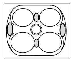
シリンダーヘッド各気筒の、左図の で印した 4箇所がピストンと干渉していないか確認してください。
