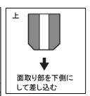
② ピンポンチを用いてΦ1.5の オリフィスを打ち込む
