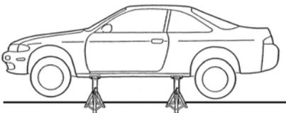
車両下側の作業ができるように車両を設置してください。
