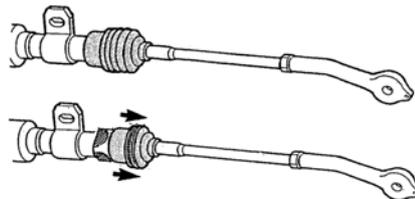
ブーツの内側のつけ根を外し、ブーツを外側に移動させてください。
