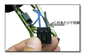
ノーマルのポンプハーネスをできるだけ長く残すように カプラーの付け根辺りでカットします。
