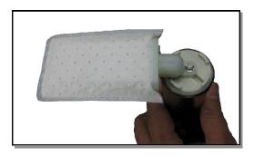
ポンプ本体に付属のフィルタ―を付属クリップを使い取り付け装着します。
