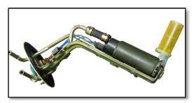
燃料ポンプを燃料タンクから取り出します。 この際、フロートをタンク等に引っ掛けて破損しないように 注意してください。
