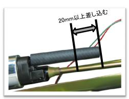
ポンプに付属のインシュレーターと座金を仮組みし、 取り付け位置を確認しパイプに印をつけ、 鉄ノコ等でパイプを切断します。
