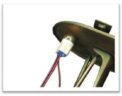
ポンプ本体下部がポンプインシュレーターに確実に収まっていることを確認し、ホースバンドを締めつけてください。 ポンプハーネスを接続し、燃料タンクへ取り付けてください。
