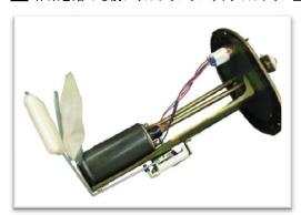
燃料ポンプを燃料タンクから取り出します。 この際、フロートをタンク等に引っ掛けて破損しないように 注意してください。
