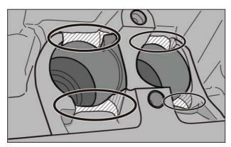
純正シリンダーヘッドの生産時の個体差などにより、 カム山とシリンダーヘッドが干渉する場合があります。 組み付け前にクリアランスを十分に確認し、 必要に応じてシリンダーヘッドの左図部分をフライスや リューターなどで切削し、カム山の逃げ加工を おこなってください。
