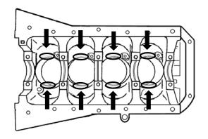
ブロックにシリンダーライナーの打ち換えを施している場合は 左図箇所がコンロッドに干渉する場合があります。 1mm~1.5mmのクリアランスが確保できない場合は フライスや、リューター等で逃げ加工を実施してください。
