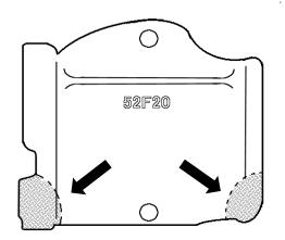
カムバッフルプレートの左図2カ所を平らになるよう削り落としてください。
