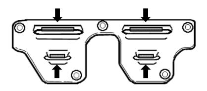
コンロッドの逃げ加工として、 1mm~1.5mmのクリアランスを 確保するよう、左図4カ所の ヤスリ加工を 実施してください。
