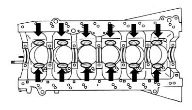
ストロークアップにともない、左図の12ヶ所が コンロッドに干渉する場合があります。 1mm~1.5mmのクリアランスが確保できない 場合は、フライスやリューターなどで逃げ加工 を実施して下さい。(◆ 部分)
