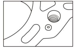
② Φ5程度のピンポンチを用いて、純正オリフィスを6ミリ打ち込む。
