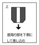
② ピンポンチを用いてΦ1.5のオリフィスを打ち込む。
