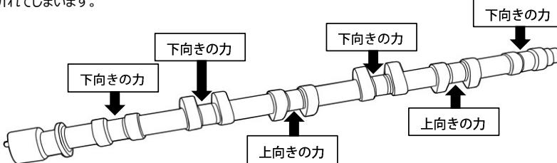
カムシャフトを組み付ける際は、できるだけヘッド面に対してカムを水平に均等に少しづつ締めていくください。
